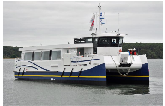
Bateau dont les batteries sont des super-condensateurs.
