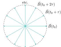
On utilise plusieurs bobines alimentées par une tension sinusoïdale, déphasée différemment selon la bobine.
