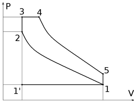
Dans les moteurs Diesel à double combustion, le cycle décrit par le mélange air-carburant peut-être modélisé (de façon idéale) par celui d’un système fermé représenté en coordonnées de Watt ci-contre.
