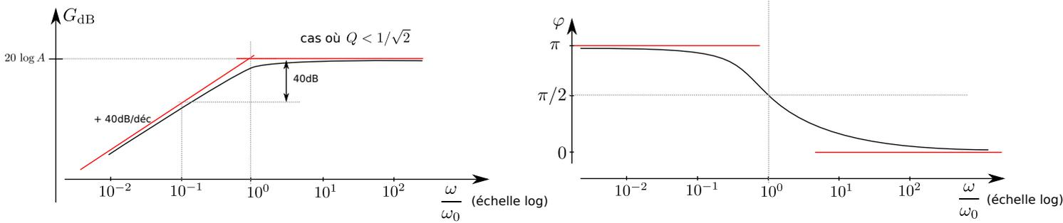
4 - Le sismomètre ne doit pas amplifier artificiellement les vibrations à une certaine fréquence. Il faut donc éviter l'existence de la résonance, et donc prendre  $Q < 1/\sqrt{2}$ .
