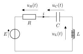
**1.a** – À  $t=0^-$  on a  $i(0^-)=0$  (car l'interrupteur est ouvert),  $u_c(0^-)=0$  (car le condensateur est déchargé).
