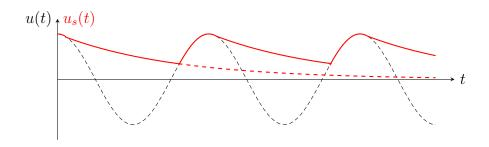
6. Si  $\tau = RC$  est très faible, alors lorsque la diode est bloquée la tension  $u_s$  tend très vite vers 0. On a donc un signal  $u_s(t)$  qui n'est pas du tout constant.
