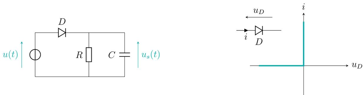
Détecteur d'enveloppe à diode. Une diode passante est équivalente à un fil, une diode bloquée équivalente à un interrupteur ouvert.
