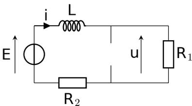
4.a – Au bout d'un temps long, le régime permanent est atteint et ici les grandeurs sont constantes dans le temps. La bobine se comporte donc comme un fil, et le circuit comporte uniquement un générateur  $E$  en série avec une résistance  $R_1$  et une résistance  $R_2$ .
