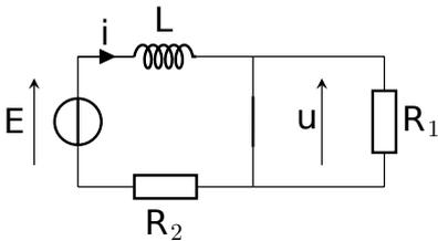
1 – L'interrupteur fermé se comporte comme un fil, de résistance nulle. Tout le courant va donc passer par ce fil, et rien ne passera par la résistance.
