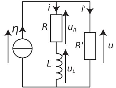
On remarque que  $i'(t)$  n'est pas continue en  $t = 0$  (il passe de 0 à  $I_0$ ). Rien d'étonnant, il ne s'agit pas du courant traversant une bobine, il peut donc être continu ou non.
