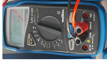
mode ampèremètre calibre 500 mA
