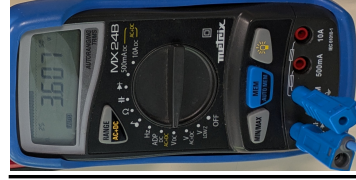
mode ampèremètre calibre 500 mA
