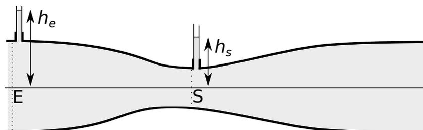
Il faut en pratique que le diamètre de la conduite soit négligeable devant la hauteur dans les tuyaux horizontaux, afin de négliger la variation de pression sur une section droite de la conduite (ou alors que l'écoulement soit laminaire, pour que la loi de l'hydrostatique s'applique horizontalement).
