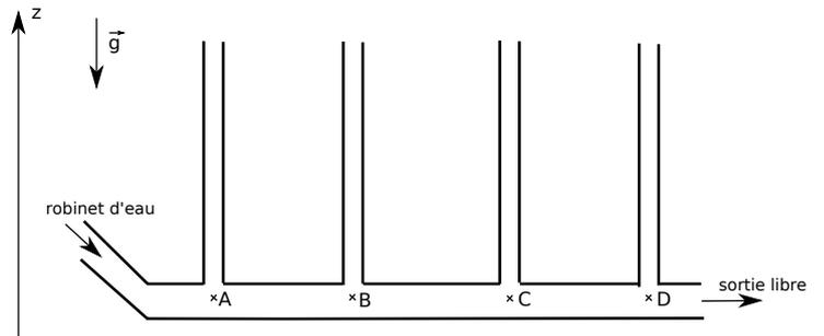
Ici l'arrivée d'eau est directement branchée sur le robinet. Notons qu'on peut aussi, si on veut contrôler la pression à l'entrée du dispositif, utiliser un vase de Mariotte (comme ci-dessous, même si ce n'est pas tout à fait un vase de Mariotte). La hauteur d'eau donne alors la pression d'entrée.
