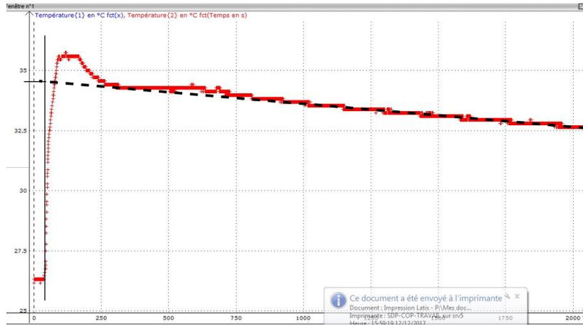
Sur la première figure on relève ainsi  $T_f = (25.7 \pm 0.2)^\circ\text{C}$  et  $T_i = (19.67 \pm 0.05)^\circ\text{C}$ .
