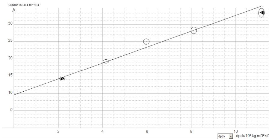
( $D_v$  en fonction de  $\frac{\Delta p_C}{L}$ . Pour les incertitudes on a retenu  $\pm 0.5$  cm pour la mesure de la hauteur dans le premier tube,  $\pm 0.25$  cm dans le dernier, et  $\pm 1$  s sur  $T$ . (incertitudes élargies))
