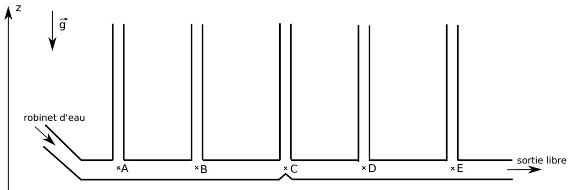
Le diamètre  $d$  du tuyau horizontal est le même que précédemment, mais il y a cette fois en  $L/2$  un rétrécissement brutal de la section du tuyau.
