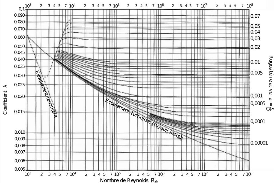
1 – Pour un tuyau lisse avec  $R_e = 5 \times 10^4$ , vérifier que le diagramme est bien en accord avec la formule de Blasius (qui donne  $\lambda = 0.316 R_e^{-0.25} = 0.021$ ).
