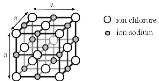
4. À l'aide de la figure ci-dessus, déterminer le nombre d'ions chlorure et d'ions sodium dans une maille.
