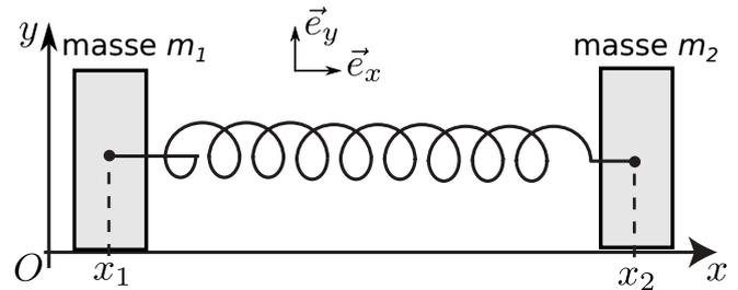
**15** - Établir l'équation différentielle suivie par la position  $x_1(t)$  de la masse  $m_1$ , puis celle suivie par la position  $x_2(t)$  de la masse 2.
