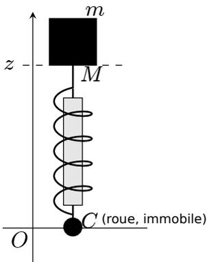
On considère la suspension avant d'un VTT, que l'on modélise comme l'association d'un ressort de raideur  $k$  et longueur à vide  $l_0$ , en parallèle avec un amortisseur de constante de frottement  $\alpha$ . La raideur  $k$  et le coefficient  $\alpha$  peuvent être réglés par l'intermédiaire de la pression en huile et en air dans la suspension.
