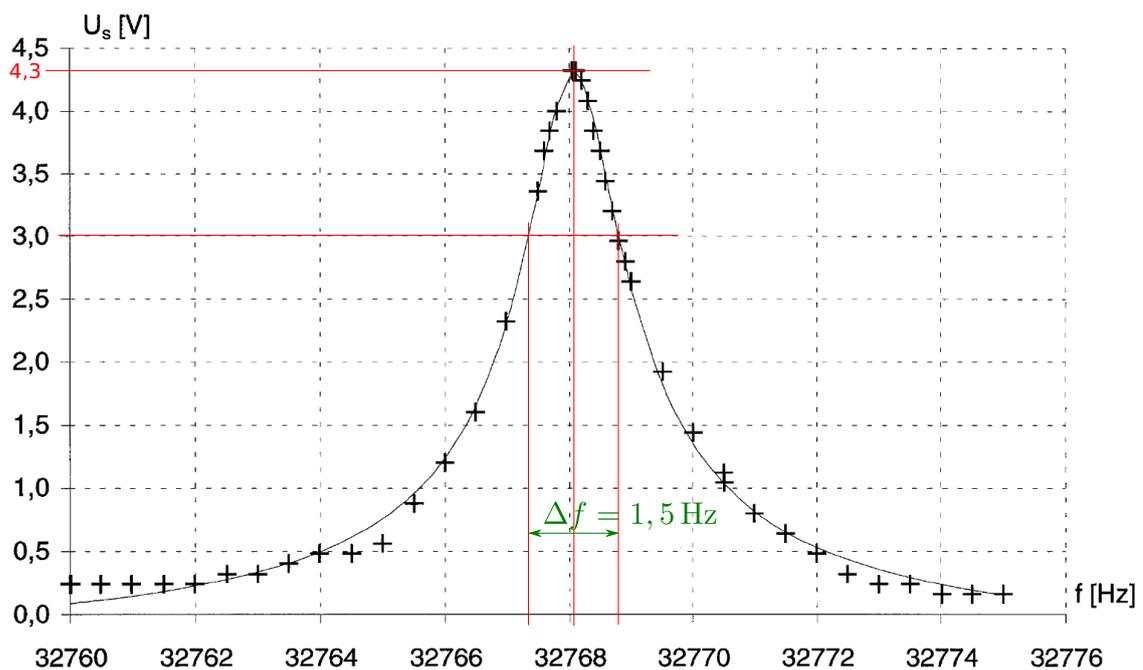
6. Mesure de la largeur  $\Delta f$  :  $4,3 \text{ V}/\sqrt{2} = 3 \text{ V}$ , on lit  $\Delta f = 1,5 \text{ Hz}$ .
