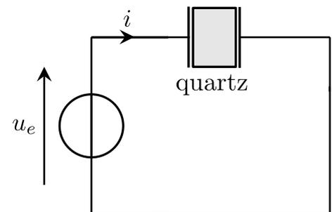
L'étude se fait en régime sinusoïdal forcé, et on utilise le formalisme complexe. On note les grandeurs complexes en les soulignant. Par exemple  $i(t) = i_0 \cos(\omega t + \varphi)$  est représenté par  $\underline{i}(t) = i_0 \exp\{j(\omega t + \varphi)\}$ .
