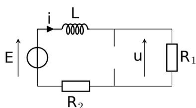
6 - Au bout d'un temps long, le régime permanent est atteint et ici les grandeurs sont constantes dans le temps. La bobine se comporte donc comme un fil, et le circuit comporte uniquement un générateur  $E$  en série avec une résistance  $R_1$  et une résistance  $R_2$ .
