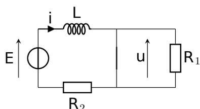
3 - L'interrupteur fermé se comporte comme un fil, de résistance nulle. Tout le courant va donc passer par ce fil, et rien ne passera par la résistance.
