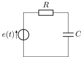
Pour  $t < 0$  le générateur est éteint (tension nulle). À partir de  $t = 0$  il délivre une tension  $E$  constante.
