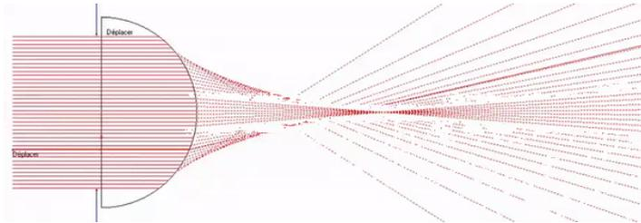
**28 -** Dans ces conditions on est dans les conditions de Gauss, et le système sera donc approximativement stigmatique.
