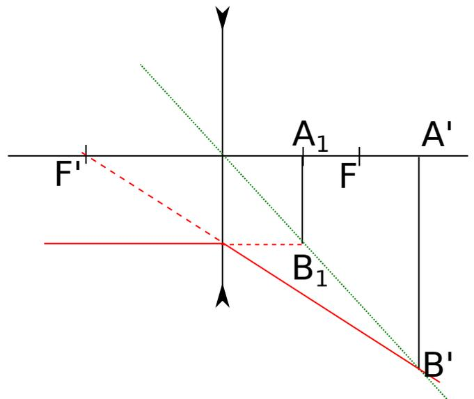
19 - D'après ce qui précède, l'image intermédiaire  $A_1B_1$  doit être entre  $O_2$  et  $F_2$  pour que son image par  $L_2$  soit réelle. Donc il faut que :
