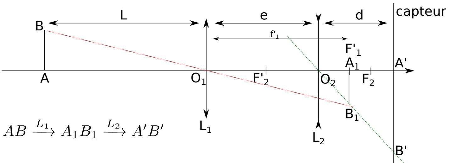
17 - Si  $L \gg f'_1$ , alors l'image de A par  $L_1$  se trouve quasiment au foyer image de  $L_1$ , c'est-à-dire en  $F'_1$ . Donc  $\overline{O_1A_1} \simeq f'_1$ .
