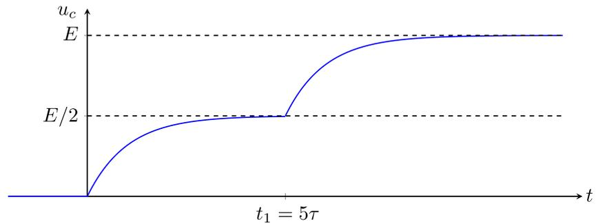
15 - On a  $i_C(t) = C \frac{du_c}{dt}$ . On passe le détail des calculs.
