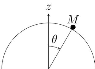
Cet exercice s'intéresse à la glissade d'un enfant esquimau de masse  $m$  sur le toit d'un igloo d'où il s'élanche (au sommet) sans vitesse initiale. On adopte le modèle suivant : l'enfant est ramené à un point matériel  $M$ , il glisse sans aucun frottement à la surface de l'igloo que l'on suppose sphérique de rayon  $R$ .
