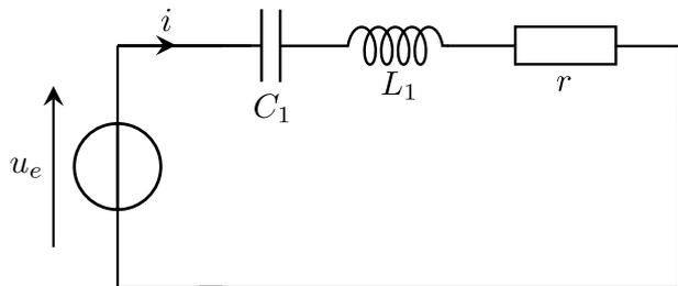
30. Montrer que  $\underline{i} = \frac{u_e/r}{1 + jQ \left( \frac{\omega}{\omega_1} - \frac{\omega_1}{\omega} \right)}$  avec  $Q = \frac{1}{r} \sqrt{\frac{L_1}{C_1}}$  et  $\omega_1 = \frac{1}{\sqrt{L_1C_1}}$ .
