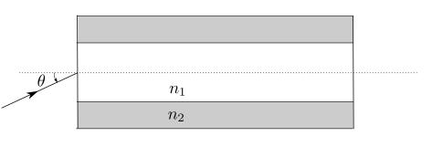
On envoie en entrée un rayon lumineux avec une incidence  $\theta$  comme sur le schéma cidessus. Le rayon est initalement dans l'air, d'indice optique 1.
